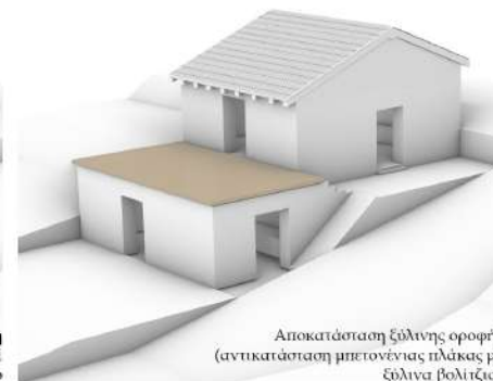
Επισκευή οροφής και αντικατάσταση κεραμιδιών στο μισό τμήμα της οροφής με γουαλί για να διωχθεί ο ήλιος στον εσωτερικό χώρο
